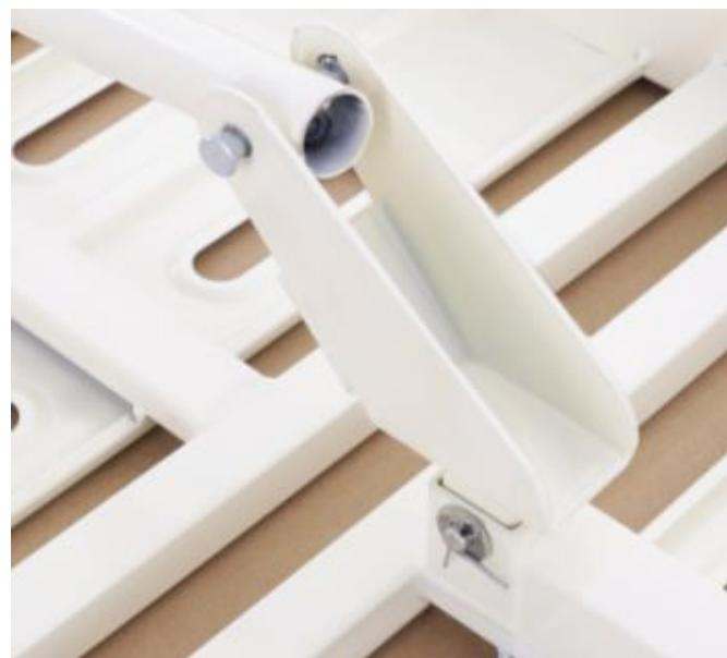
2. Соедините шток каждого линейного актуатора электропривода с открытым концом тяги стальным пальцем. Зафиксируйте палец шплинтом.
